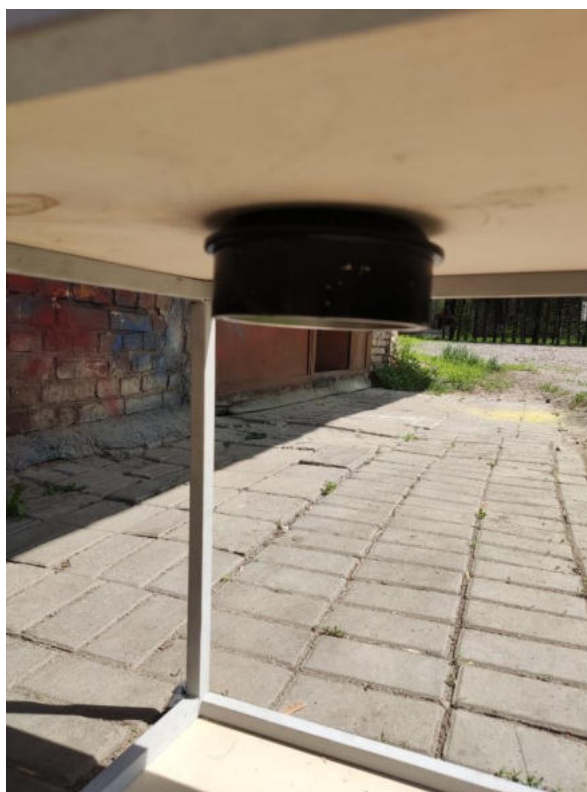
Рисунок 3.13 - Закрепленный корпус статора на верхней плоскости куба
