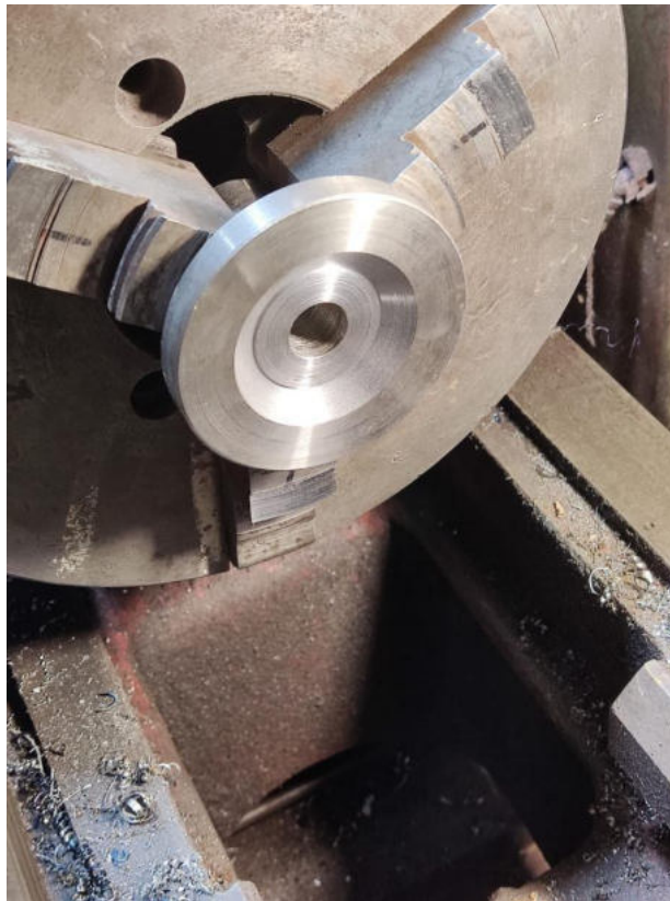
Рисунок 3.10 - Ступица для генератора, в процессе создания
