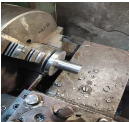
Рисунок 3.9 - Процесс вытачивания ступиц на токарном станке
