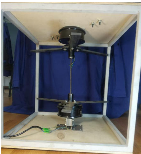
Рисунок 3.17 - Полностью собранная конструкция, соединенная гибким валом-тросом
