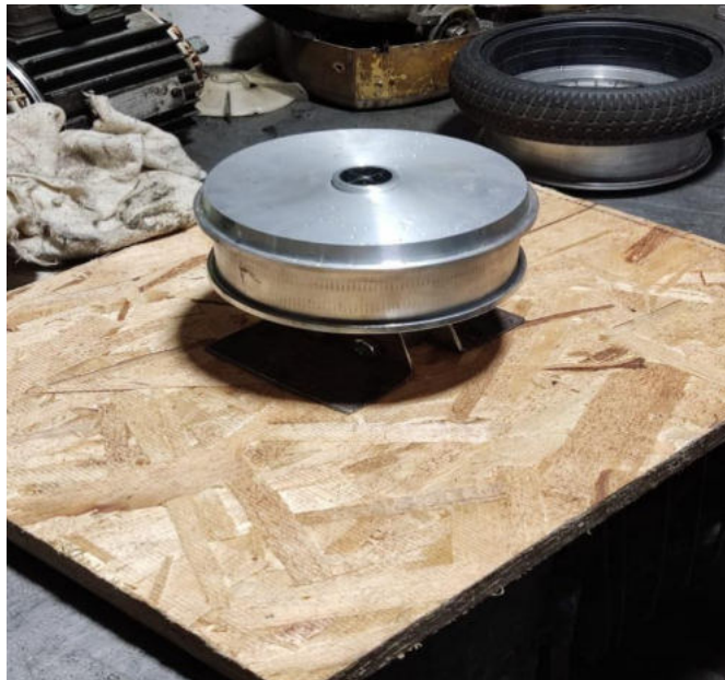
Рисунок 3.8 - Мотор-колесо после обработки на токарном станке
