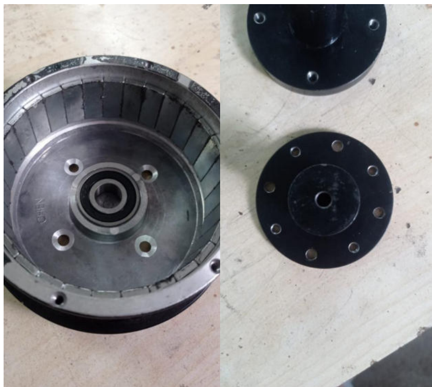
Рисунок 3.11 - Статор с отверстиями и ступица с отверстиями с резьбой М6
