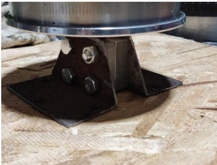
Рисунок 3.6 - Крепление нижнего электродвигателя на фанере, пробный вариант
